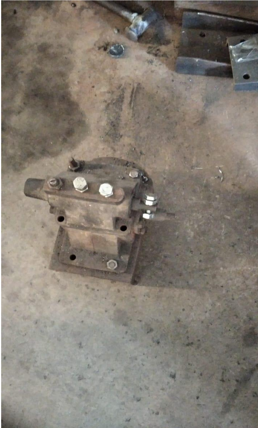
Lampiran 6. Gear pump yang terkontaminasi
