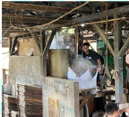
Gambar 1. 6 Tempat penyaringan tahu yang terlalu tinggi tanpa adanya alat bantu
