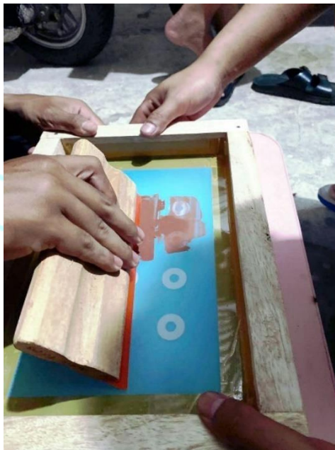
Gambar 3.3. Proses Screen-Printing pada Katalitik Konverter
