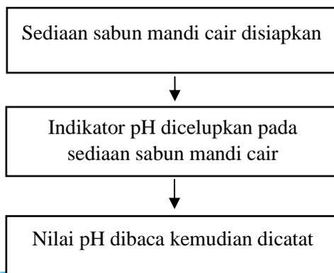
**Gambar 3.3** Skema Uji pH
