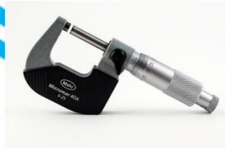
Gambar 3.4 Mikrometer
