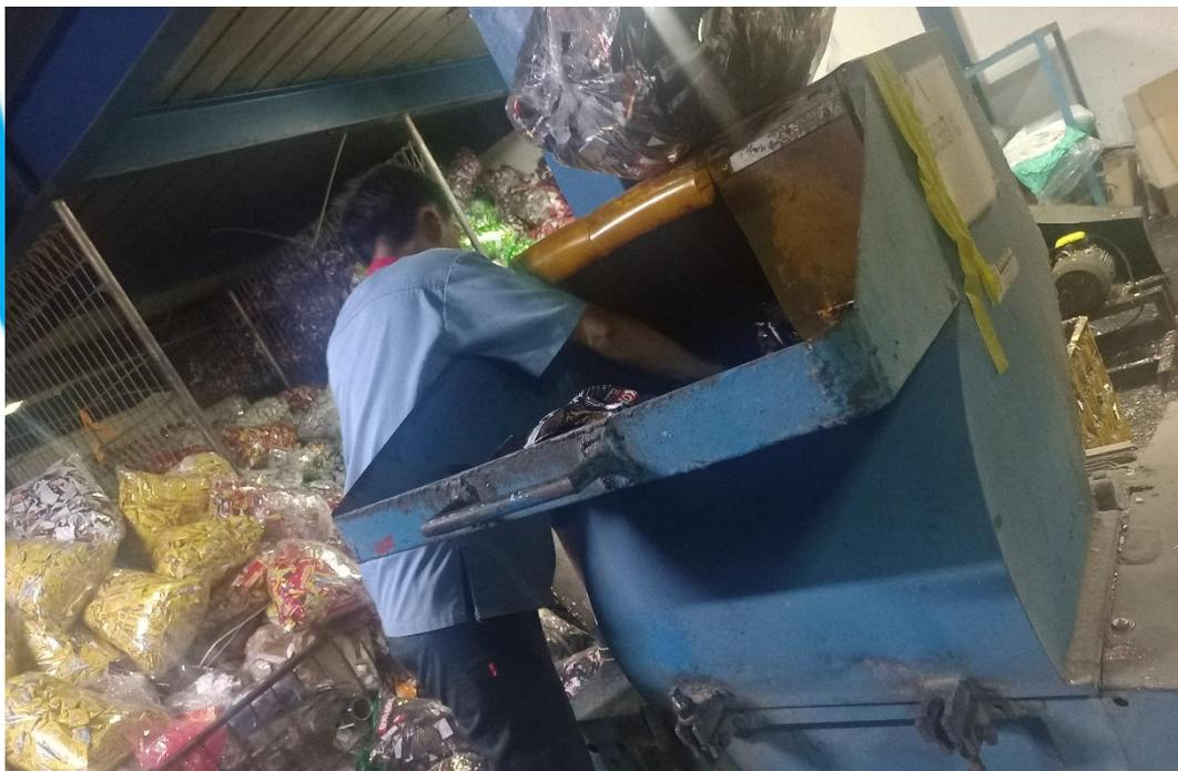
**Gambar 1. 2** Proses penggilingan kemasan *reject* dengan mesin *Clucher Inner*
