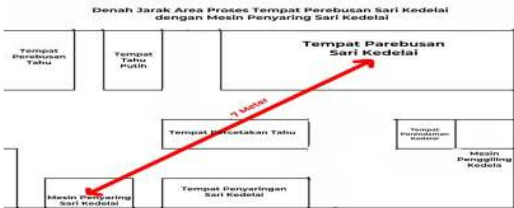
**Gambar 1. 2** Denah Mesin Penyaring Sari Kacang Kedelai Dengan Tempat
