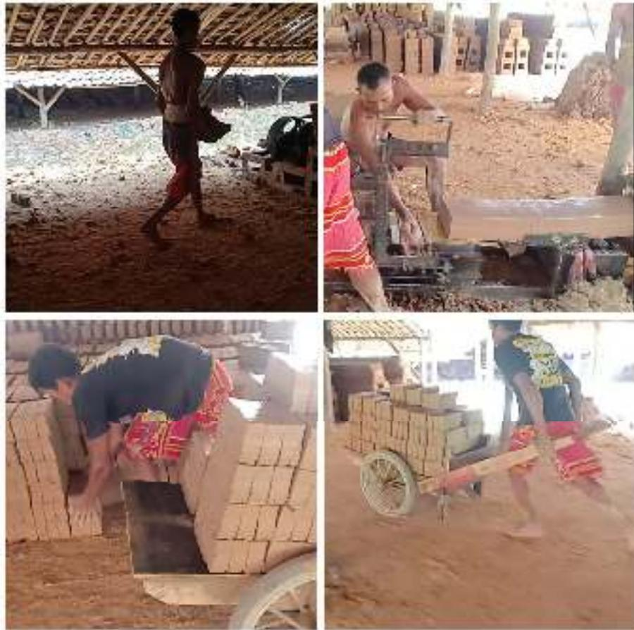
**Gambar 1.1** Proses percetakan bata merah
