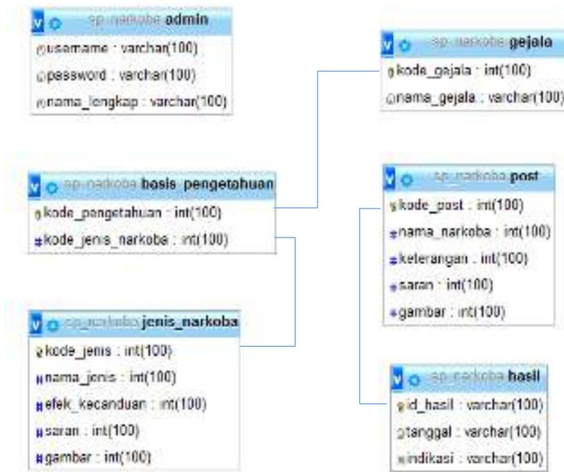
Gambar 3. 4 Gambar desain *database* sistem pakar
